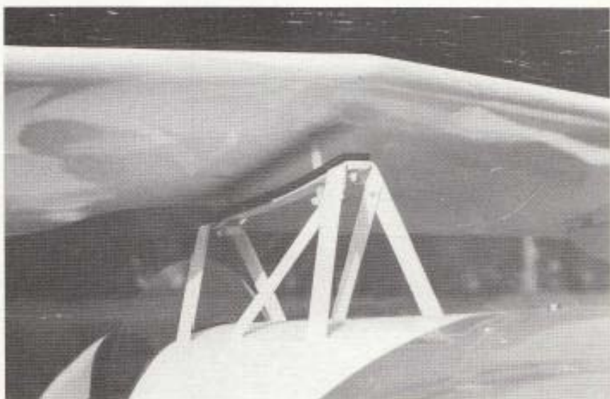
Die Befestigung des oberen Tragdecks auf dem stabilen Pylon mittels zweier Kunststoffschrauben
