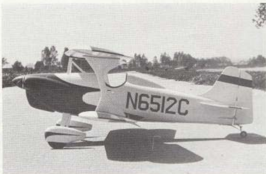
Seitenansicht. Die beiden Tragdecks sind positiv gestaffelt, die Verbindungsstreben stabil und funktionsell. Die Radverkleidungen vermindern den Strömwiderstand
